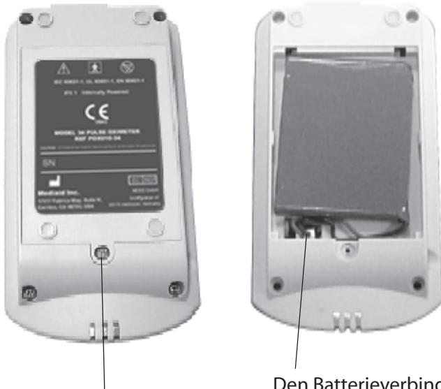
Um die Batterieeinschließung zu öffnen die Schraube entfernen, die hier angezeigt wird
