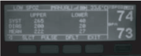
Figura 10: Colocación de los límites de la alarma para NIBP
