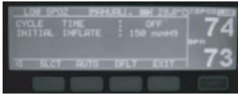
Figure 20: Paramétrages de la durée du cycle NIBP et de l'inflation initiale
