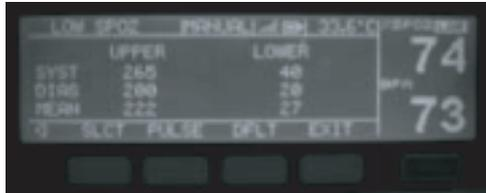
Figure 10 : Paramétrage des limites de l'alarme NIBP
