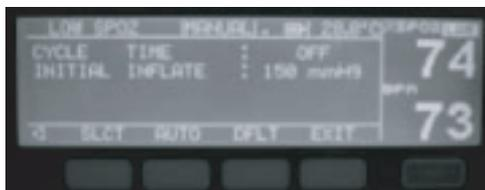
Figura 20: Tiempo del Ciclo NIBP y colocación de Inflado Inicial
