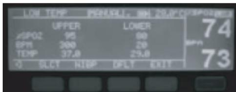
Figura 9: Colocación de los valores límites de alarma para SpO<sub>2</sub>, LPM y Temperatura
